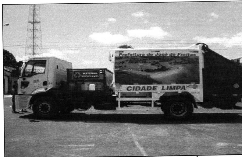
FIGURA 2.286 – EXEMPLO DE VEÍCULO INDICADO PARA COLETA DE REJEITOS E RESÍDUOS RECICLÁVEIS EM LOCALIDADES DISTANTES DO ATERRO E DA USINA DE TRIAGEM Fonte: Prefeitura Municipal de José de Freitas-PI (2013)
