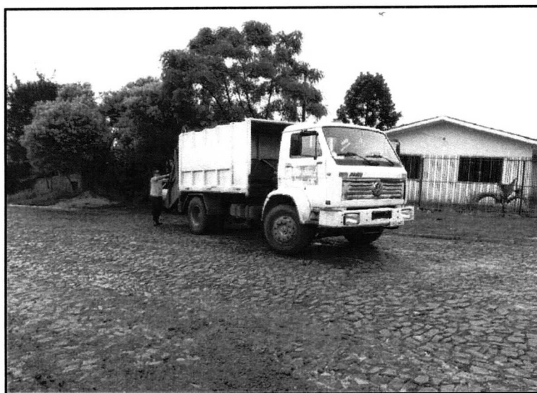
FIGURA 2.56 – CAMINHÃO COMPACTADOR VOLKSWAGEM ANO 1998, UTILIZADO PARA COLETA DE RESÍDUOS DOMICILIARES NA ÁREA URBANA. FONTE – PREFEITURA MUNICIPAL DE PITANGA, 2014.
